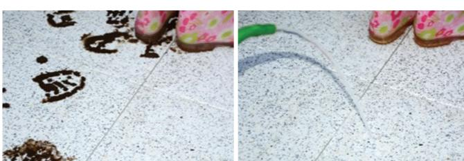
Impregnace pronikne do pórů a kapilár na povrchu dlaždice, kde vytváří kvalitní ochranu proti vnikání kapalin. Povrch dlažby se hydrofobizuje (odpuze vodu), ale současně nedochází k omezení difuze vodních par, aby přirozená vnitřní vlhkost měla možnost unikat. Díky impregnaci se také snižuje možnost vzniku výkvětů.
